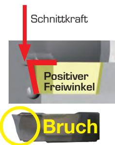
Der negative Freiwinkel der Zentrumsschneide erhöht die Leistung und verhindert Bruch.
